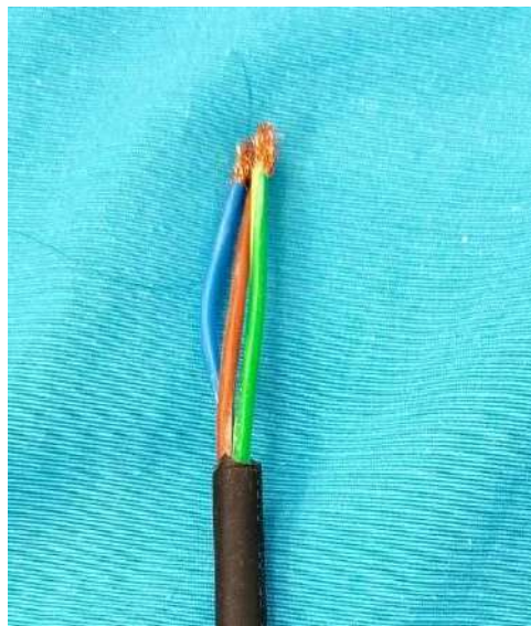
Foto 7 - Fiação externa da amostra.
